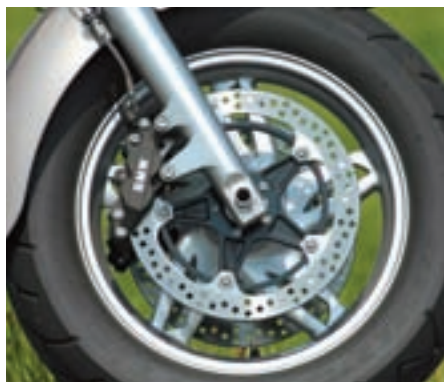
Kao i kod modela CL, i prednji kraj Montauk-a se odlikuje masivnom prednjom gumom dimenzija 150/80-16"
