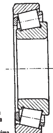
Konusno valjkasti ili stožasti ležaj rjeđe se upotrebljava u moto tehnicu, no tu i tamo ga nalazimo na glavčinama upravljača i na diferencijalnim sklopovima
