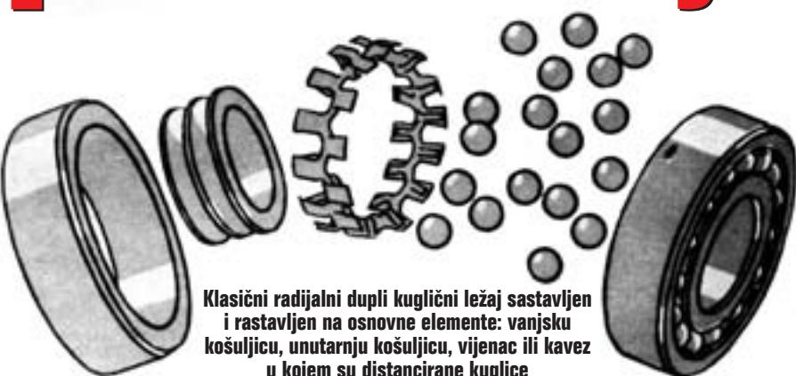
**Klasični radikalni dupli kuglični ležaj sastavljen i rastavljen na osnovne elemente: vanjsku košuljicu, unutarnju košuljicu, vijenac ili kavez u kojem su distancirane kuglice**
