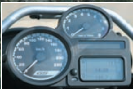
Instrument ploča sa digitalnim LCD displejom nudi najpotrebnije informacije, a parcijalnim brojačima upravlja se uz pomoć tipke na lijevoj strani upravljača
