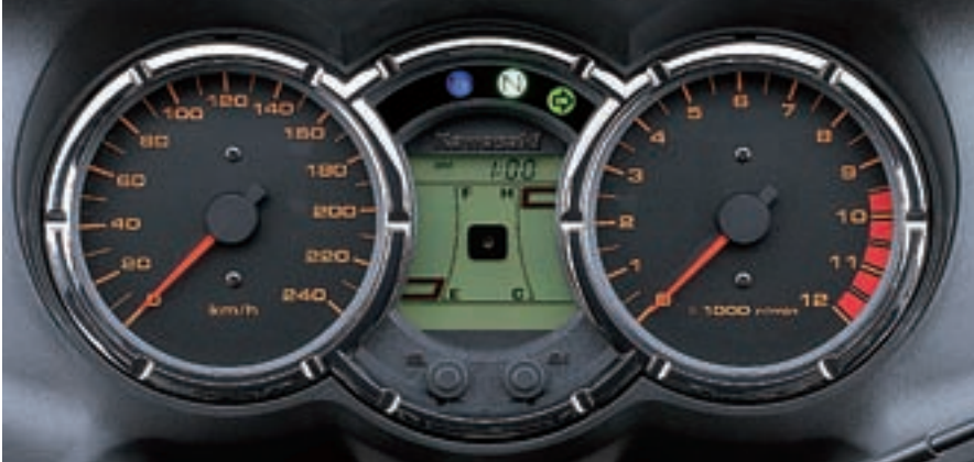
Instrumenti su potpuni i pregledni, kombinacija klasičnog analognog tipa i modernog digitalnog tipa. Nedostaje jedino putni kompjuter
