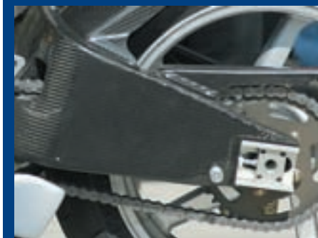
Stražnja vilica je izvedena kao rešetkasta konstrukcija koja je s vanjske strane obavijena u plašt od ugljičnih vlakana
