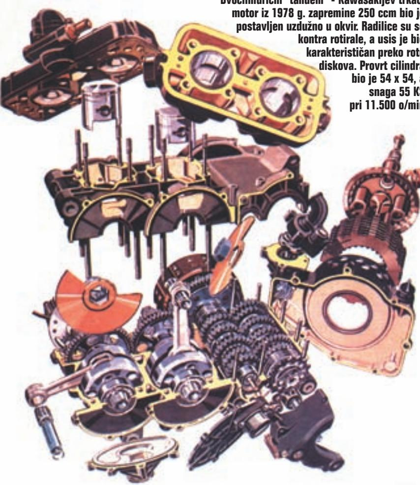
Dvcilindrični "tandem" - Kawasakiev trkači motor iz 1978 g. zapremine 250 ccm bio je postavljen uzdužno u okvir. Radilice su se kontra rotirale, a usis je bio karakterističan preko roto diskova. Provrt cilindra bio je 54 x 54, a snaga 55 KS pri 11.500 o/min
