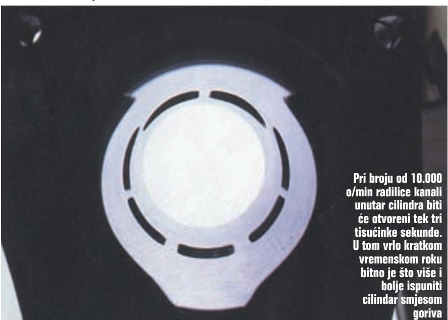
Pri broju od 10.000 o/min radilice kanali unutar cilindra biti će otvoreni tek tri tisućinke sekunde. U tom vrlo kratkom vremenskom roku bitno je što više i bolje ispuniti cilindar smjesom goriva
