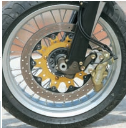
Plivajući disk promjera 320 i kočiona čeljust "triple bridge" s četiri klipčića i četiri kočione pločice, kao i na hipersportskim modelima. Teško je nešto bolje i poželjeti
