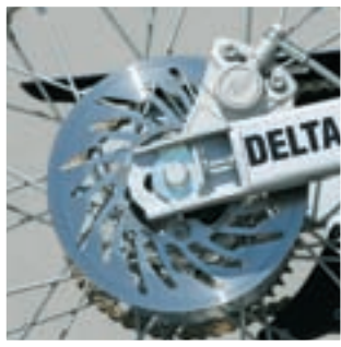
Stražnji disk promjera 220 mm
