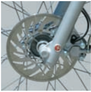
Disk promjera 245 mm na koji djeluju dvoklipna kočiona klješta
