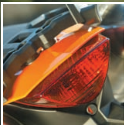
Bravica za podizanje sjedala smještena je ispod štop svijetla
