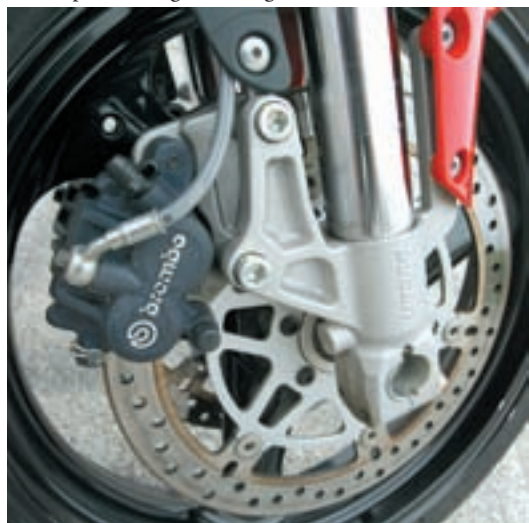
Dvostruki diskovi promjera 300 mm na koje djeluju dvoklipna kočiona klješta. Malo više agresivnosti ne bi joj škodilo
