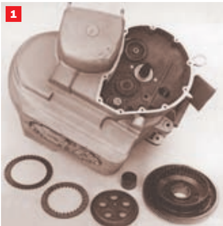
[1,2,3] Ovaj motor MV - modeli 600, 750 Sport i 800 Amerika bio je vrlo sličan natjecateljskom, no umjesto 4 ventila po cilindru imao je samo 2. Specifično podijeljeno kućište motora slično je današnjem
