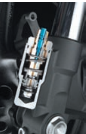
Prednji i stražnji amortizeri dobili su finu regulaciju brze i spore kompresije
