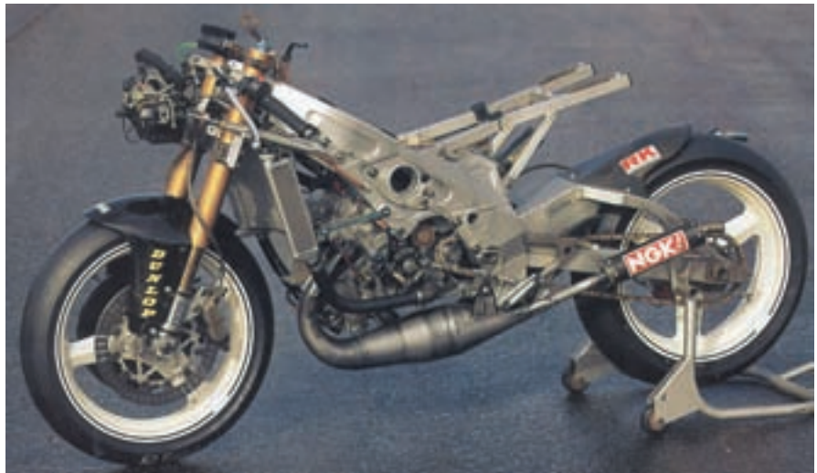
Na ovoj trkačkoj Yamaha 250 iz 1994. godine vidljiv je ispušni sustav koji je vrlo sličan svim ostalima od 125 ccm (2 x 125u ovom slučaju), sa nešto duljom izlaznom cijevi
