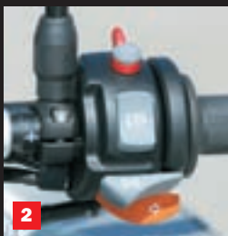
(1) Instrument ploča modernije izvedbe na kojoj se ističu dva analogna instrumenta, obrtomjer i pokazivač brzine, i LC display (2) Klasični BMW-ovi prekidači sa opcijom grijanja ručica (3) Lijepi i veliki aluminijski nosač za kofer
