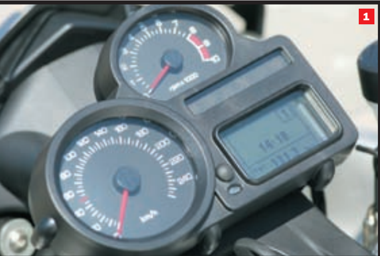
(1) Instrument ploča modernije izvedbe na kojoj se ističu dva analogna instrumenta, obrtomjer i pokazivač brzine, i LC display (2) Klasični BMW-ovi prekidači sa opcijom grijanja ručica (3) Lijepi i veliki aluminijski nosač za kofer
