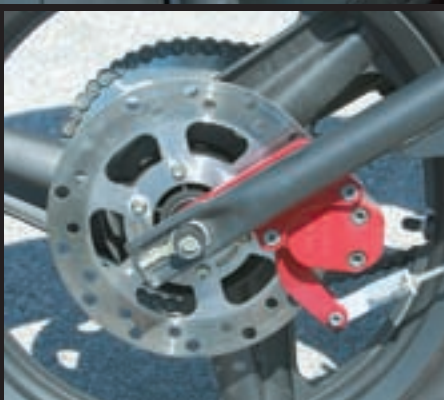
Prednji disk promjera 260 mm na koji djeluju dvoklipne kočione čeljusti. Stražnji disk od 215 mm tako nema hidrauličnu, već mehaničku komandu. Ispušni sustav je izveden kao na današnjim najprestižnijim sportskim motociklima, ispod sjedala
