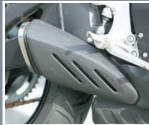
Završni ispuh izgleda smiješno mali, ipak sve bitno je ispod motora
