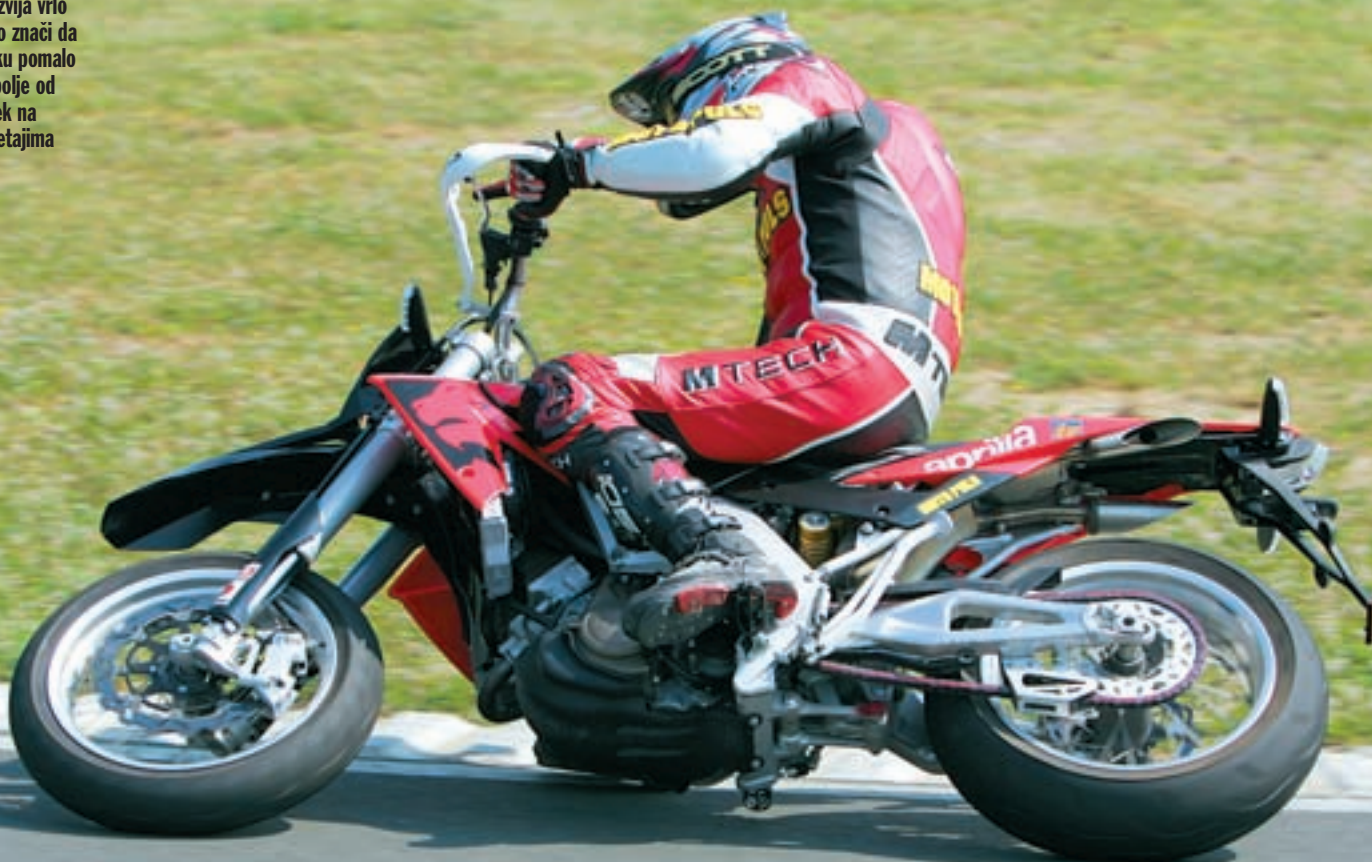
Straga se ugrađuje, za ovu klasu, ogromna guma dimenzija 180/55-17
