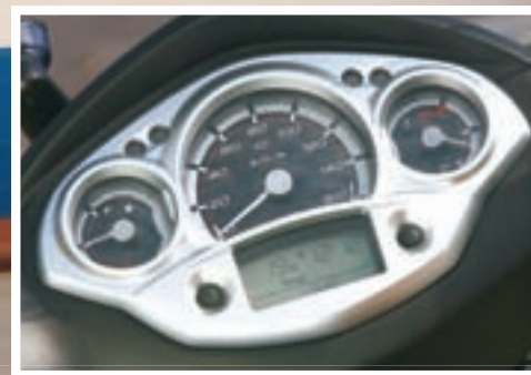
▲ Instrumenti sadrže podatak o vanjskoj temperaturi, vrlo koristan za zimsko korištenje skutera
