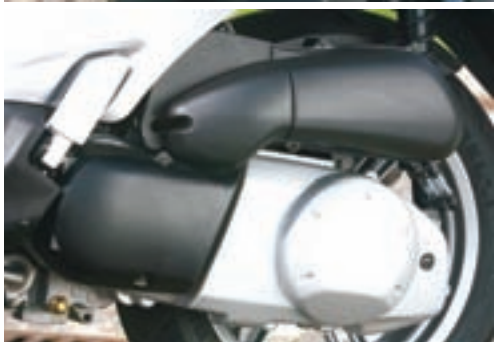
Provjerena mehanika preuzeta od X-Maxa 250. X-City ima ubrizgavanje goriva i 1 KS jači agregat: maksimalnih 21,2 KS
