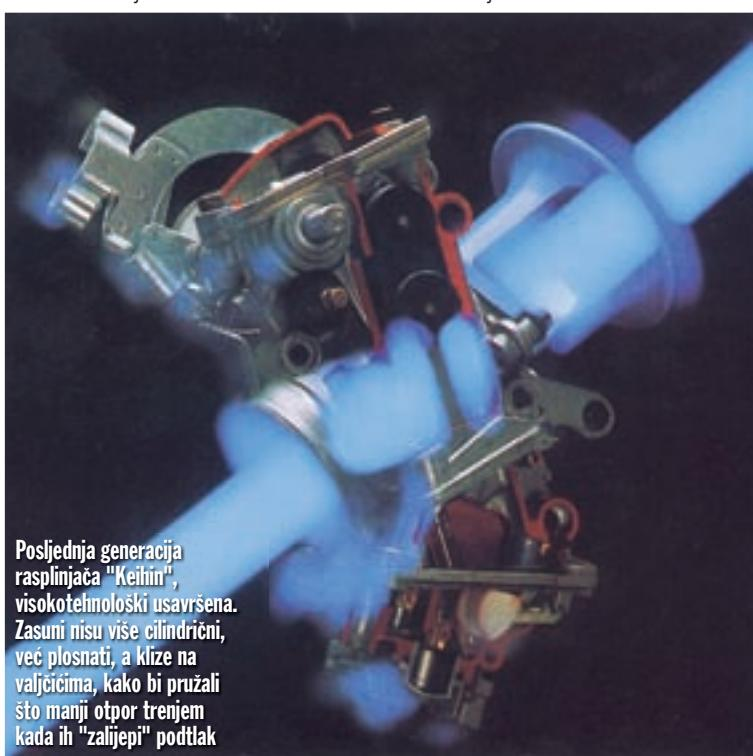
Posljednja generacija rasplinjača "Keihin", visokotehnološki usavršena. Zasuni nisu više cilindrični, već plosnati, a klize na valjčićima, kako bi pružali što manji otpor trenjem kada ih "zalijepi" podtlak
