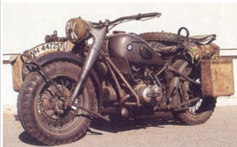
▲ Posljednji vojni model iz II Svjetskog rata tvrtke BMW je R75. Ovdje "pod punom ratnom spremom", ekstremno opterećen i opremljen. Motor je u bokser izvedbi od 750 ccm i 26 KS
