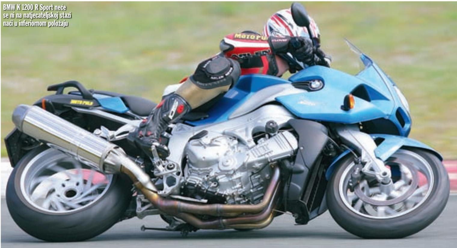
Za razliku od inače zrakom hlađenih boxer motora karakterističnih za BMW-ove motocikle, serija K odlikuje se tekućinom hlađenim rednim četverocišljničnim agregatima
