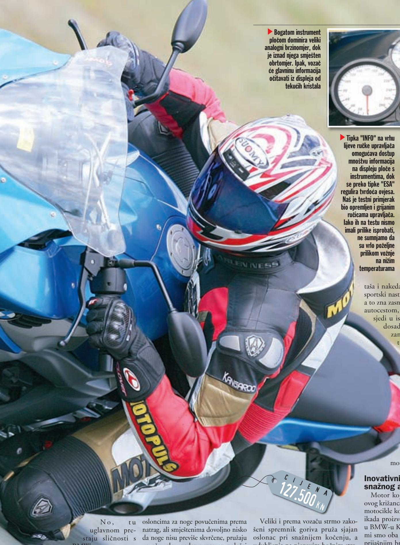
► Bogatom instrument pločom dominira veliki analogni brzinomjer, dok je iznad njega smješten obrotomjer. Ipak, vozač će glavnu informaciju očitavati iz displeja od tekćih kristala
