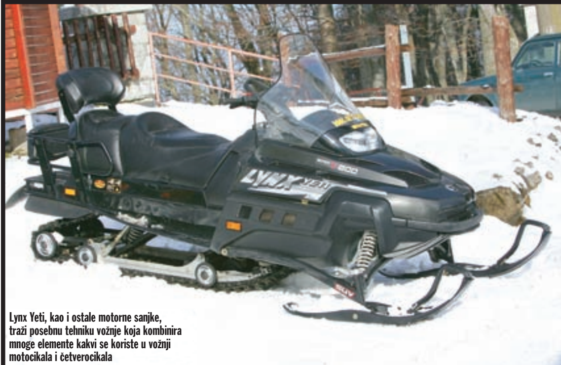
Masivna stražnja gusjenica ovješena je putem monoamortizera i na prvi pogled djeluje mehanički puno jednostavnije od gusjenica koje se ugrađuju na četverocikle
