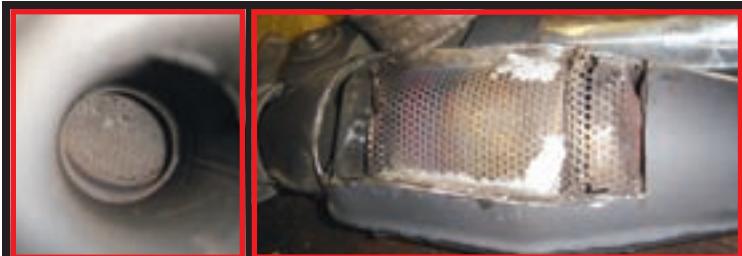
Katalizator je smješten duboko u unutrašnjosti ispuha. Vađenje katalizatora je opsežan posao obzirom da zahtjeva rastavljanje, rezanje i sastavljanje ispušnog sustava
