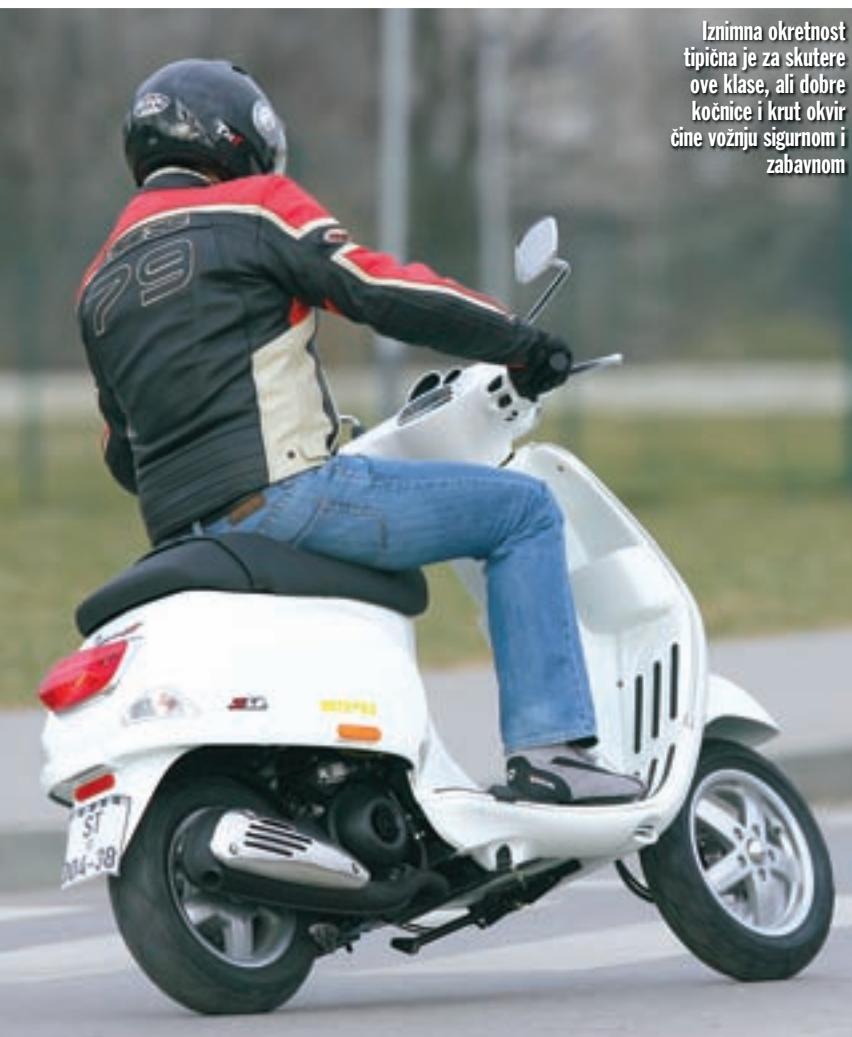
Kao i bazni model LX iz kojeg je razvijen, model S počiva na petokrakim aluminijskim naplatcima promjera 11" sprijeda te 10" straga
