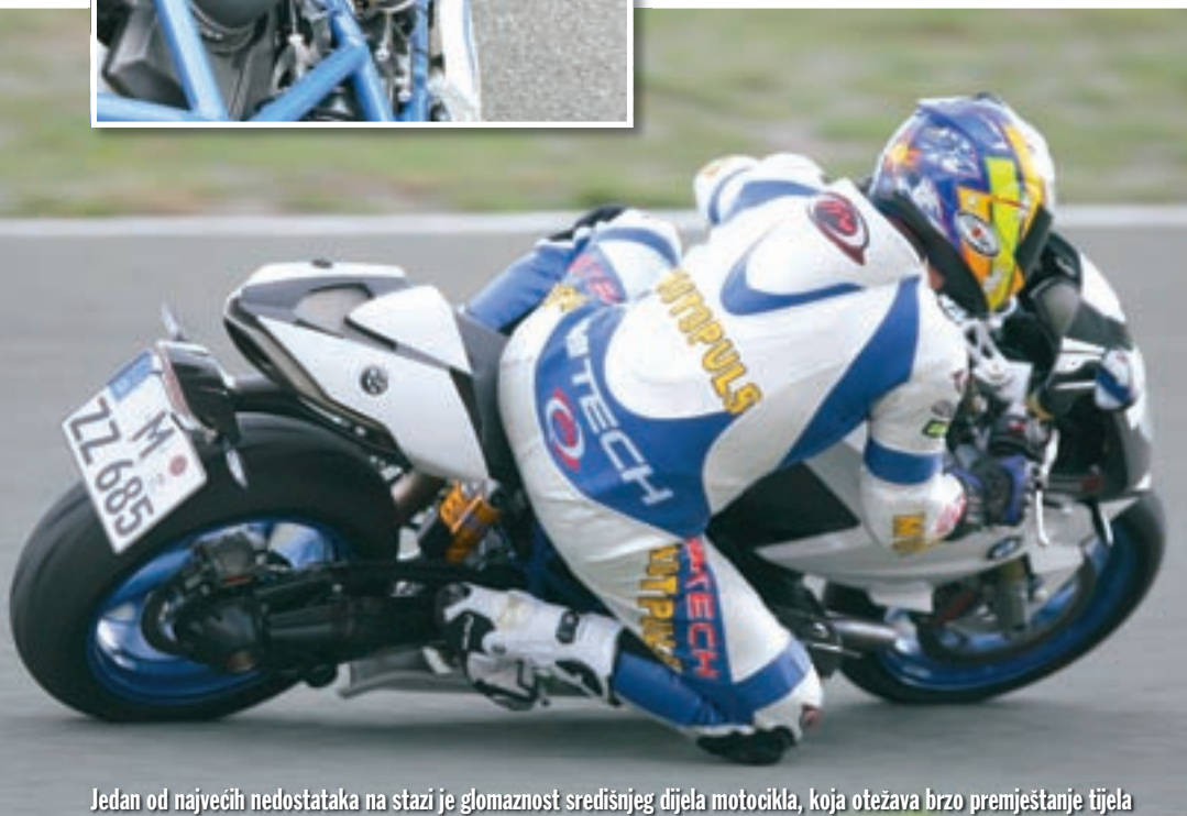
Naplatci su izvedeni od kovanog umjesto lijevanog aluminija, što se povoljno odražava na smanjene rotacionih masa i ukupne težine motocikla
