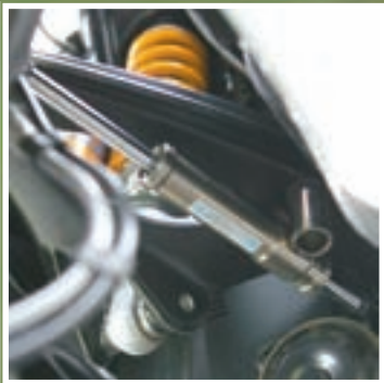
▲ Izuzmemo li kliznu spojku, HP2 Sport ima sve što jednom sportskom motociklu treba. Uključujući i amortizer upravljača
