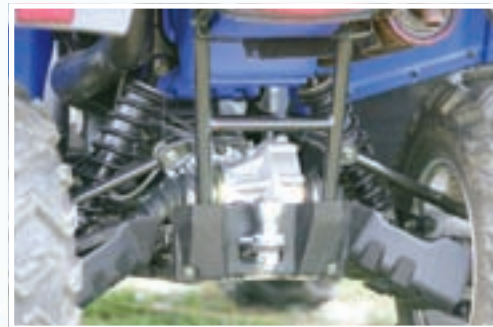
Straznji nezavisni ovjes ima dvostruka poprečna ramena, s tim da je donje poprečno rame dodatno zašticeno
