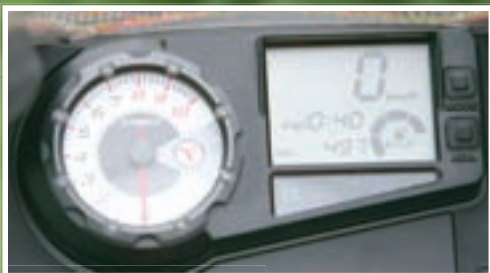
▲ Ploča s instrumentima je dovoljno atraktivna i precizna, no zbuñuje to što crveno polje otpočinja već na 8.000 okr/min
