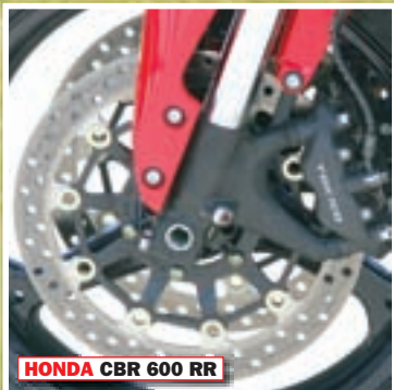
Zaustavna snaga svih motocikala na testu je podjednaka, a i dimenzije kočnica su vrlo slične. Jedini se od društva izdvaja Kawasaki s diskovima promjera 300 mm, dok Honda, Suzuki i Yamaha koriste diskove promjera 310 mm
