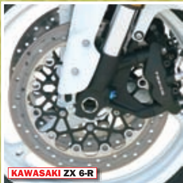
Zaustavna snaga svih motocikala na testu je podjednaka, a i dimenzije kočnica su vrlo slične. Jedini se od društva izdvaja Kawasaki s diskovima promjera 300 mm, dok Honda, Suzuki i Yamaha koriste diskove promjera 310 mm
