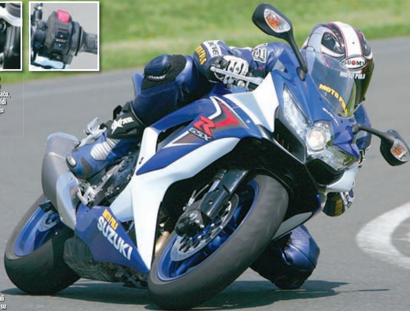
Novi, glomazni prigušivač ispušnog sustava takav je kako bi se zadovoljili sve stroži propisi o buci
