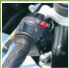
Modovi rada motora mijenjaju se pomoću prekidača na upravljaču, a odabrani mod se vidi na digitalnom displeju instrument ploče
