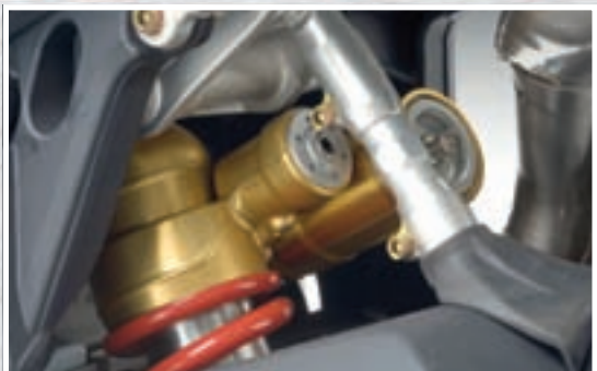
Fina regulacija stražnjeg amortizera omogućava podešavanje preopterećenja opruge, brze i spore kompresije i povrata, kao i visine samoga amortizera
