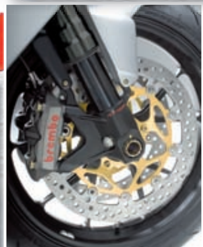
Brembo Monoblock kočnice doista su impresivne, kako svojim izgledom, tako i zaustavnom silom kojom djeluju na diskove promjera 320 mm
