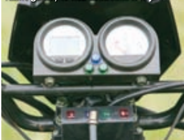
Ploča s instrumentima sastoji se od digitalnog brzinomjera i pokazivača razine goriva, te niza kontrolnih žaruljica
