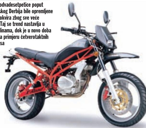
inferiori. Kratke cijevne izvedenice daju ovom obliku okvira veliku čvrstoću, otpornost na torziju, a opet nisu previše kruti. Moderni okviri ovakvog tipa male su mase zbog vrlo tankih stjenki cijevi (od svega 1,25 - 1,5 mm). I još nešto: Iako to nije više praksa, cijevni se okvir uvijek dade popraviti, dok je kod onih iz aluminijskih legura to mnogo teže.
