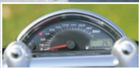
◀ Kontrolni instrumenti su svedeni na minimum. Uz brzinomjer je tu pokazivač količine goriva te prijeđenih kilometara
