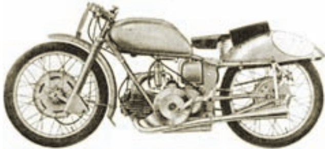
Evolucija modela 250 "Gambalungino" od 1949. do 1952. godine. Lijevo se vide prva poboljšanja ciklistike, kočnice, ovjes i ispuh. Na desnoj slici vidi se aerodinamički napredak, rezervoar za ulje nalazi se u sastavu spremnika za benzin, a i karburator je novost
