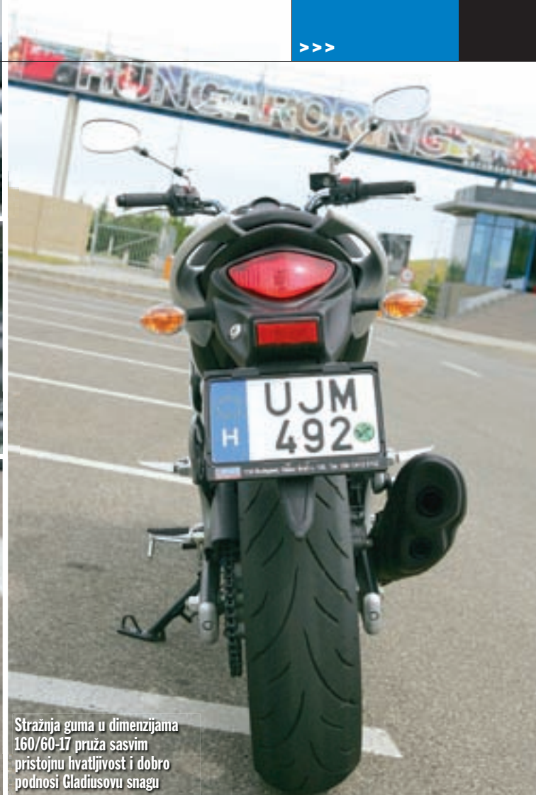
Stražnji rasvjetni sklop smješten je u gornjem dijelu nosača tablice
