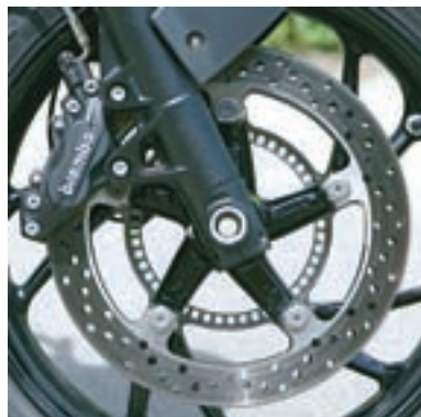
Kočnice s dva diska promjera 320 mm naprijed i jednim od 265 mm straga dovoljno su snažne i za puno veće motocikle, a naš je testni model isto bio opremljen i ABS-om
