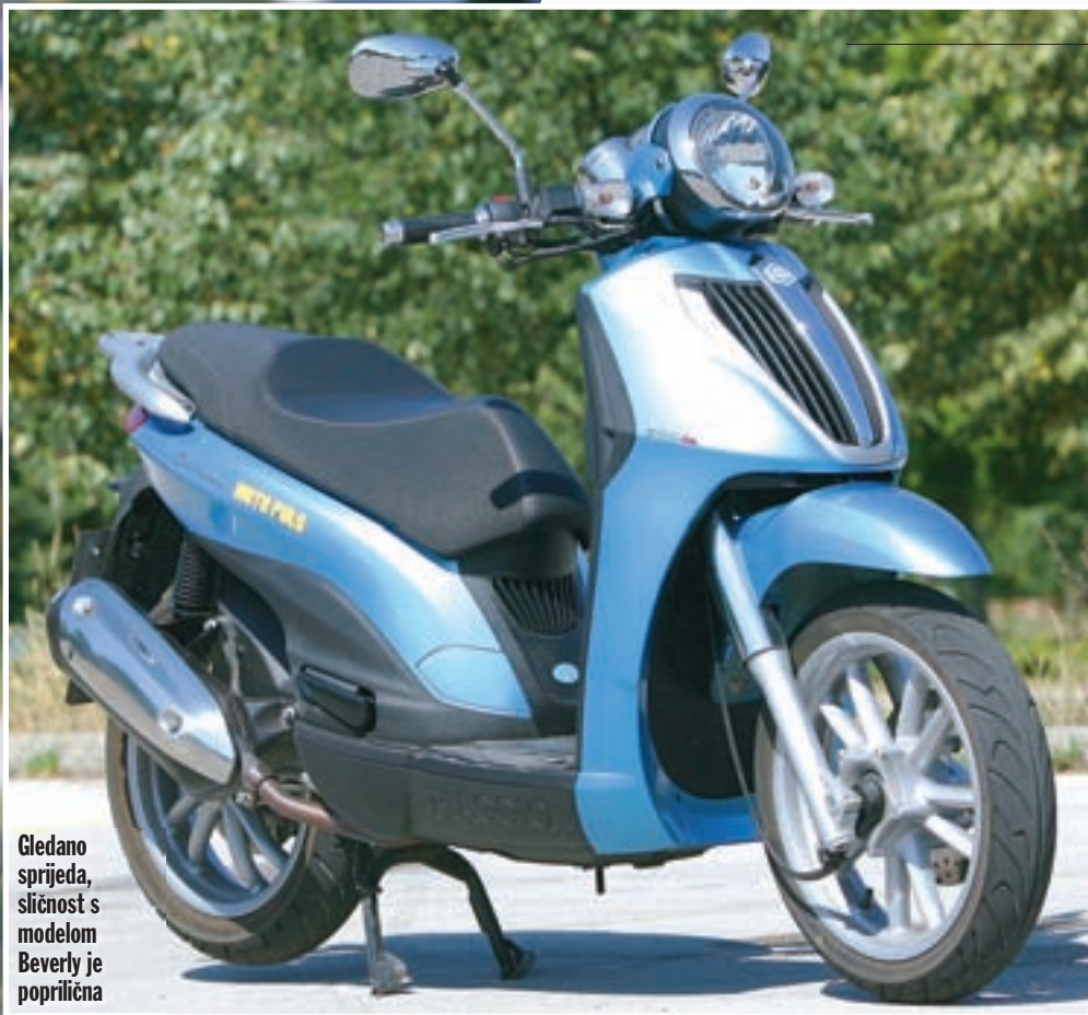
Carnaby koristi, za Piaggio uobičajena dva diska promjera 260 mm, po jedan naprijed i jedan straga
