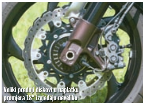
Vmax je opremljen odličnim ABS sustavom
